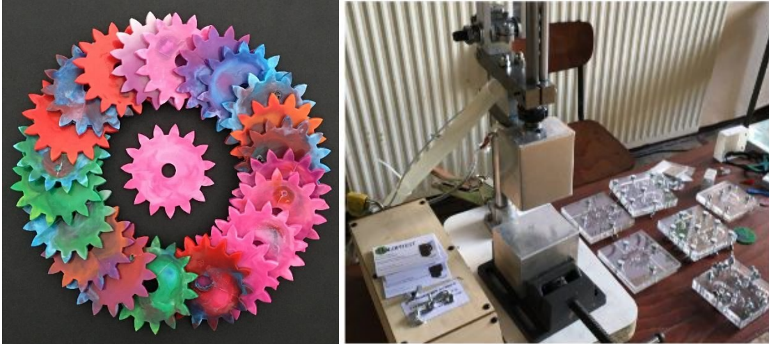
Engrenages réalisés avec la presse, et la presse à injection manuelle de plastique Holipress.
